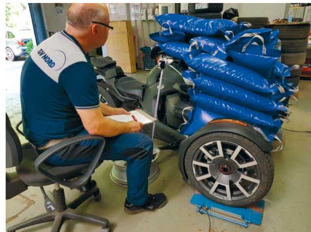
Zertifizierung: Seit 2005 lässt sich JSS vom TÜV Nord überprüfen. Hier wird die Federkennlinie ermittelt.
