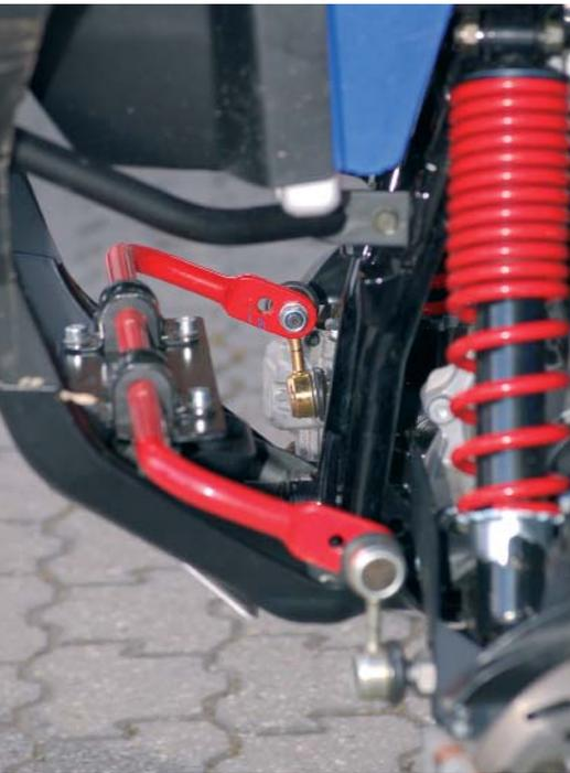
**Der Stabilisator wird vorne montiert.**
